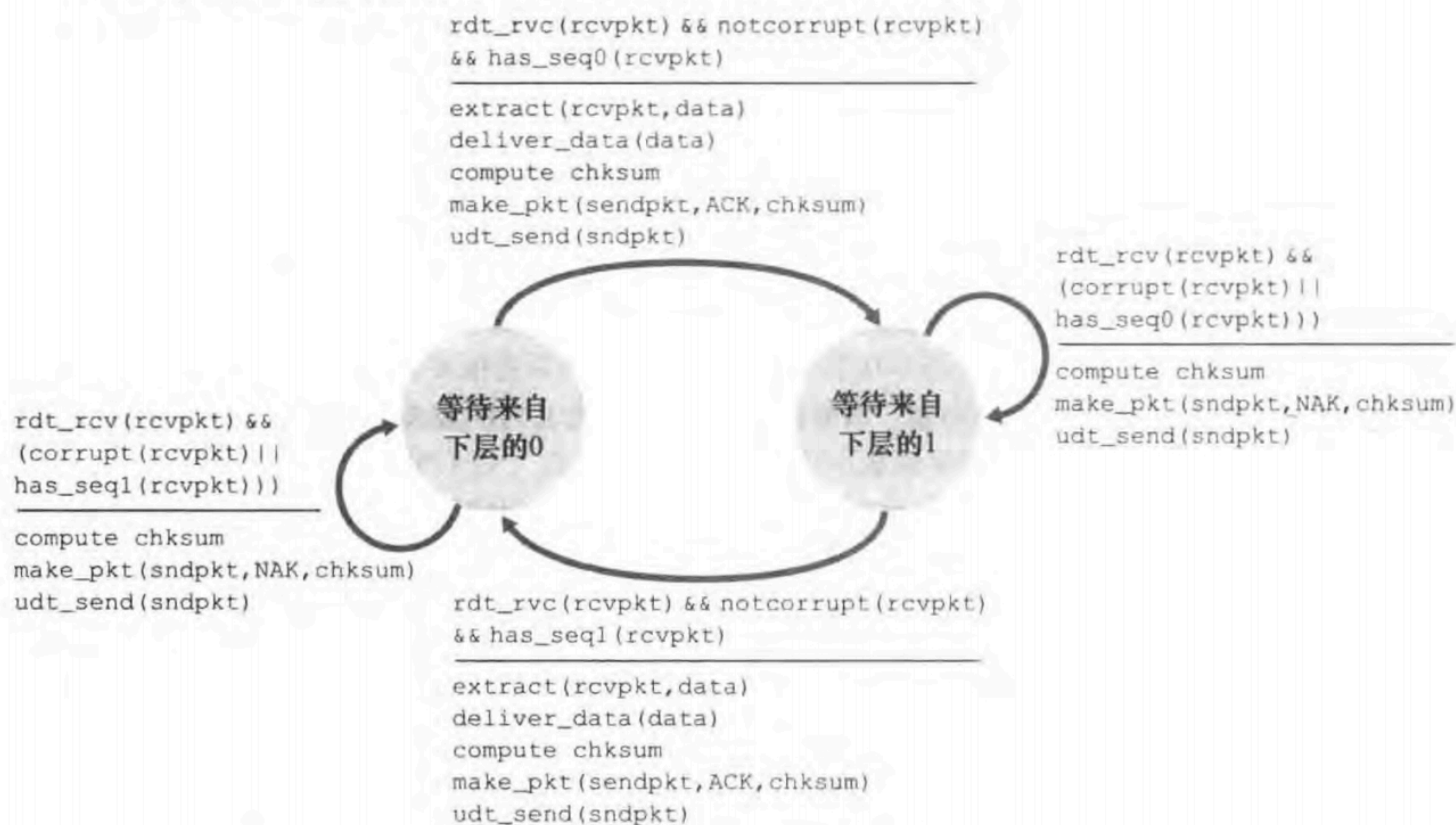
图 3-57 协议 rdt2.1 的一个不正确的接收方
